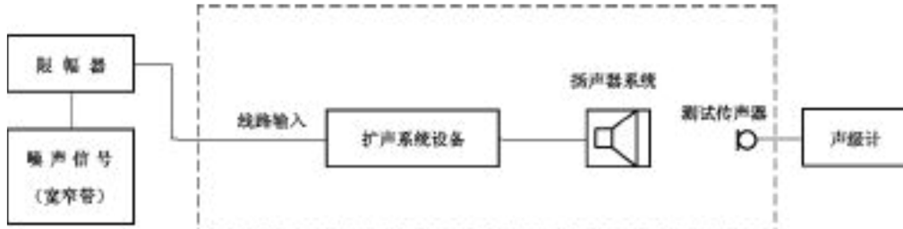
图 4 电输入法中用窄带噪声测量最大声压级原理框图
