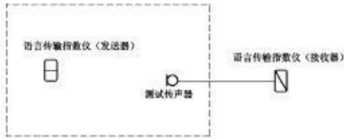
图 14 无扩声时 STI 法测量原理框图
