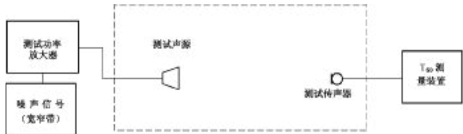
图 11 用模拟自然声源进行混响时间测量的原理框图
